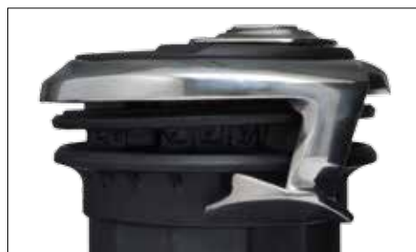
"Self-tailingen" har ingen konventionell kilform utan en fjäderbelastad lamell som håller linan i spåret utan att skapa friktion. Armen som leder upp linan på "Self-tailingen" är tillverkad i högglanspolerat rostfritt stål.
