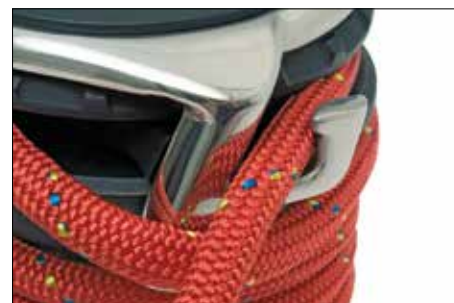
Vinschens utmatare är väl rundad. Skotet kan lossas snabbt vid en stagvändning.
