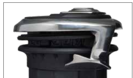
Der Selftailing-Mechanismus hat nicht die traditionelle Keilform, sondern im Innenbereich liegen die Zahnkränze annähernd parallel. Ein Federmechanismus hält die Schot zuverlässig in den Zahnkränzen. Der Führungsarm ist aus hochglanzpoliertem nichtrostendem Stahl.
