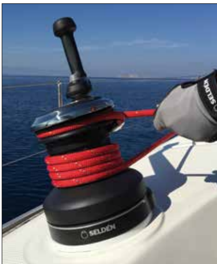
Der gute Halt auf der Trommel und die geniale Selftailer-Konstruktion ermöglichen es, bei in den Selftailer eingelegter Schot und eingesteckter Kurbel, die Lose in der Schot durchzuholen.
