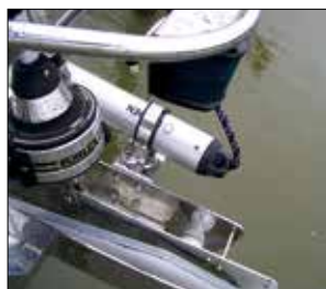
Montering på sidan av ett bogankarbeslag.
