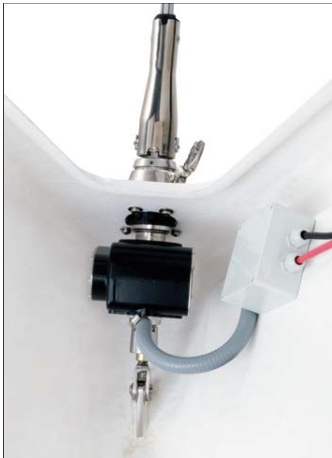
Installation sous le pont d'un Furlex 200E. Le boîtier de connexion est étanche.
